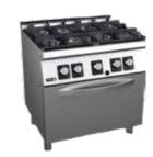
Produit conçu en acier inox AISI 304, de 1,5 mm d'épaisseur, plan de travail embouti. Allumage brûleur manuel. - Veilleuses de basse consommation et thermocouples placés dans le corps du brûleur pour une meilleure protection - FOUR STATIQUE À GAZ GN-2/1 EN SOUBASSEMENT: - Four statique pour paella de dimensions GN 2/1, avec les commandes placées sur le panneau supérieur
